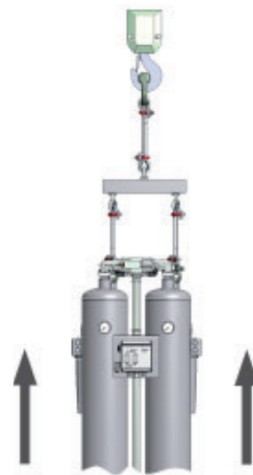
II: Aufstellen mit Kran
