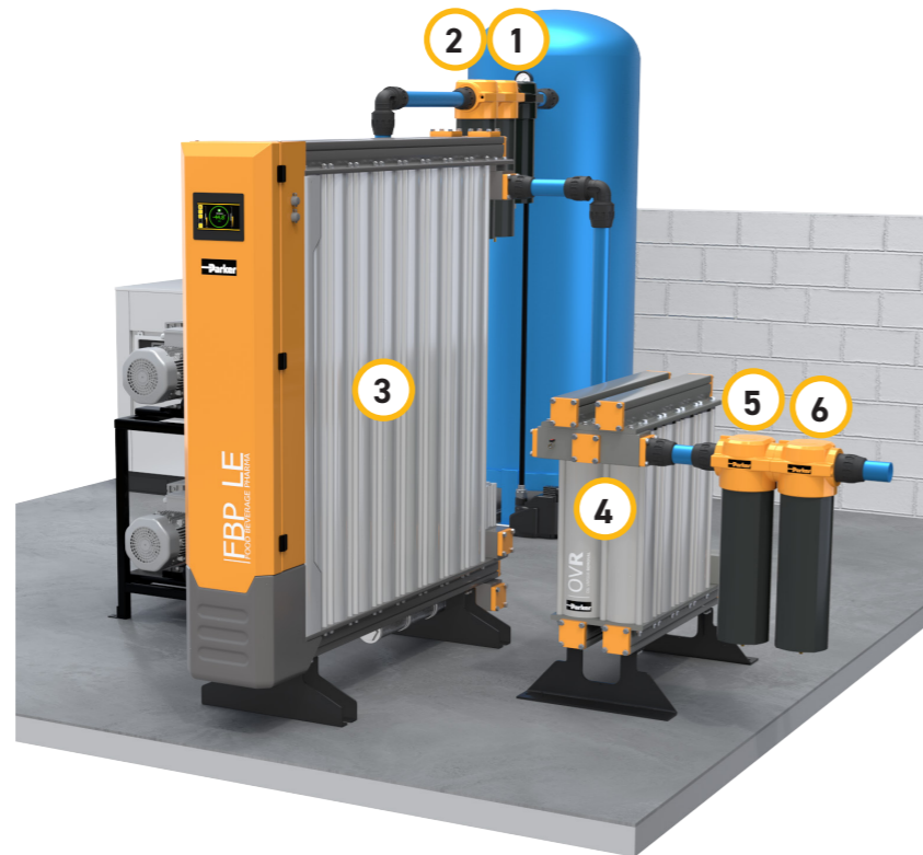
Repräsentative Installation der Modelle FBP LE 100 bis FBP LE 170 mit HLVP Vakuumpumpen (Modelle 100 bis 140 verwenden eine einzelne Vakuumpumpe, Modelle 150 bis 170 verwenden eine Duplex-Vakuumpumpe)
