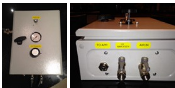
Stickstoffverdünner für den Versuch mit maximalen Restsauerstoffwerten in Kaffeepackungen.
